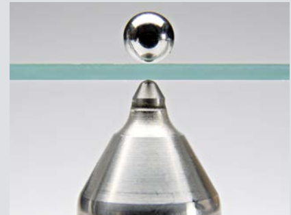
Speziell behandelte Referenzstahlkugeln zur Sicherstellung einer maximalen Reproduzierbarkeit der Messwerte
